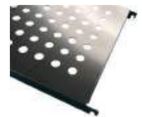
Lochboden 1.0 mm stark Ø 24 mm Lochgröße Teilung 50 mm
