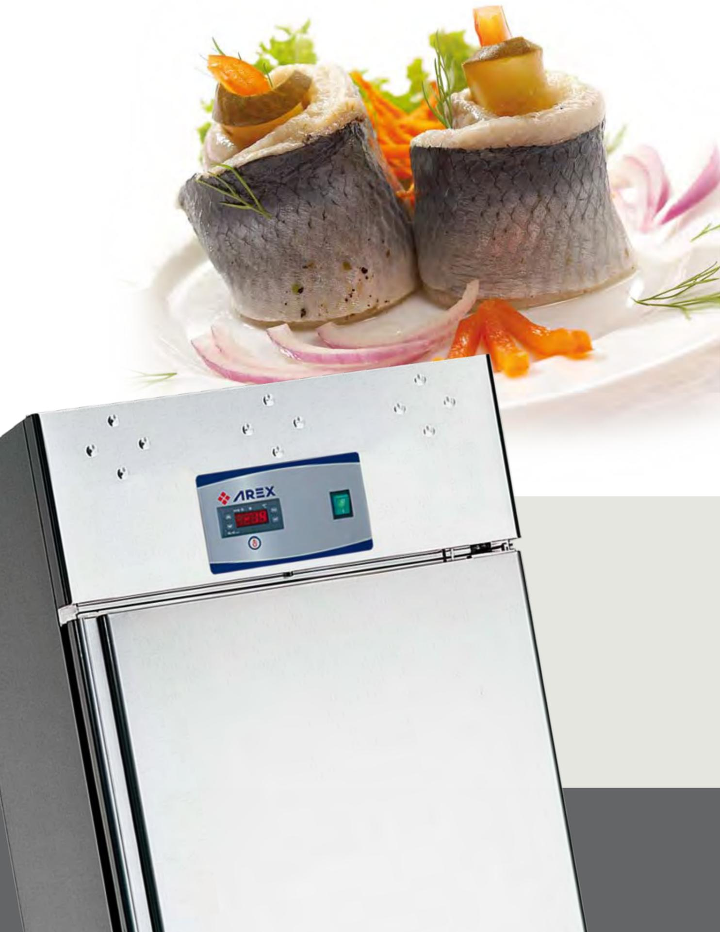
Realizzati in acciaio inox AISI 304 Cr.Ni. 18/10 con interno trattato a specchio con angoli arrotondati. Realizzati con schiume poliuretaniche ecologiche con espansione ad acqua prive di CFC, spessore isolante 60 mm ad alta densità (40 kg/mc), gas R404. Controllo temperatura di fine sbrinamento, evaporatore di serie verniciato. Ventilazione indiretta lungo lo schienale. Tutti dotati di piedini rotondi in acciaio inox Ø 56 mm regolabili +/- 50 mm, dotazione di 3 griglie per porta.
