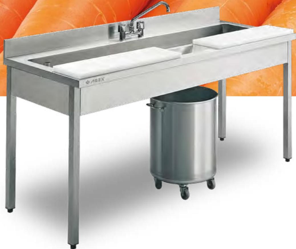
Strutture portanti realizzate completamente in acciaio inox AISI 304 Cr.Ni. 18/10, finitura scotch-brite con rivestimento anteriore e laterale a copertura vasche, su gambe in tubolare 40x40 mm e rivestimento o armadiati con ante a battente o scorrevoli (coulisse), tutti completi di piedino di livellamento.
