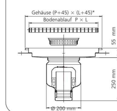
**Aussparungen zur Installation der Bodenabläufe mit vertikalem Abfluss:**
