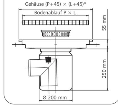
**Aussparungen zur Installation der Bodenabläufe mit horizontalem Abfluss:**
