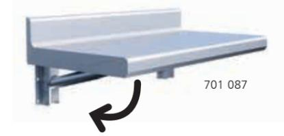
Konstruktion nach Maß aus Edelstahl. Oberseite Stärke 1,5 mm mit Aufkantung. Wandbefestigung an 2 Gelenkträgern, die ein Einklappen der Arbeitsplatte ermöglichen. Die Abmessungen sind bei der Bestellung anzugeben, max. Länge 1400 mm, Tiefe 450 bis 700 mm. Aufpreis auf den Preis für Hängetische aus Edelstahl nach Maß mit Aufkantung, Art.-Nr. 701 087 - Preis: 655 €.
