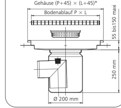
**BODENABLÄUFE MIT EINTEILIGEM TRAGEGEHÄUSE**
