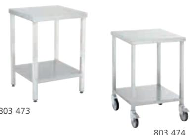
Geschweißt. Aus Edelstahl mit 40 x 40 mm regelbaren Füßen (0/+25mm). Arbeitsplatte 1,5mm, Boden 1,2mm. Maximale Tragfähigkeit: 150 kg. Rolltisch: 4 Lenkrollen verzinkt Ø 125mm, 2 mit Bremsen.
